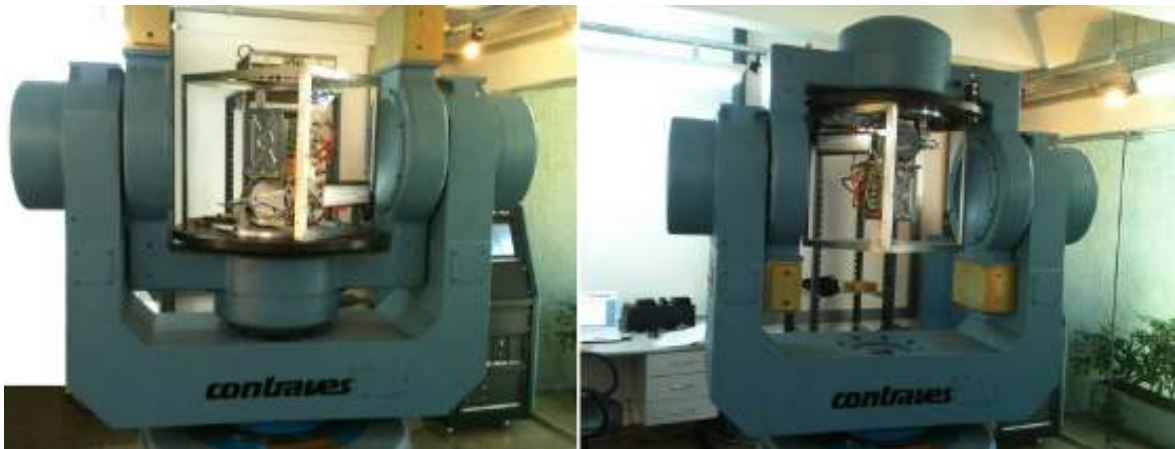
Figura 1. Plataforma Contraves - Mesa de 3 eixos com compartimento interno a 0° (esquerda) e 180° (direita)
